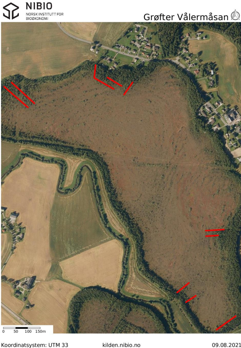
Figur 2: Flybilde av Vålermåsan, med gamle grøfter markert i rødt.
