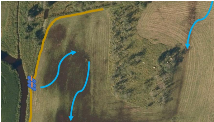
Figur 10. Flomoverløp fra Lierelva, rør med lukkeventil
