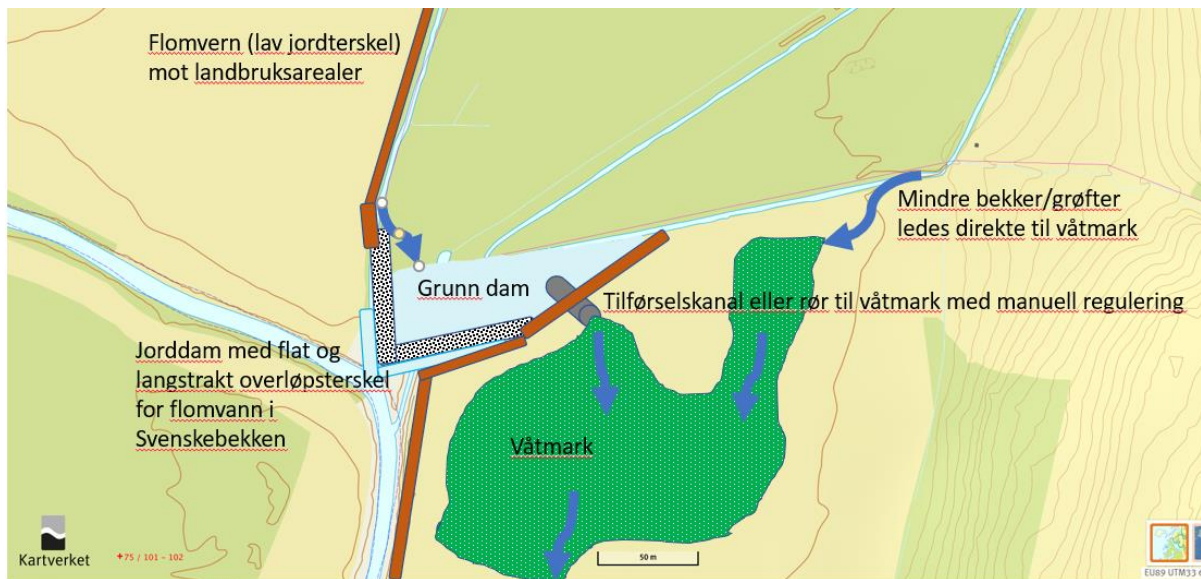
Figur 4. Eksempel på utforming av terskeldam i Svenskebekken hvor flomvann ledes til Lierelva og øvrig vannføring leder til våtmark (prinsipp tegning for det ble foretatt høydemålinger og befaring)
