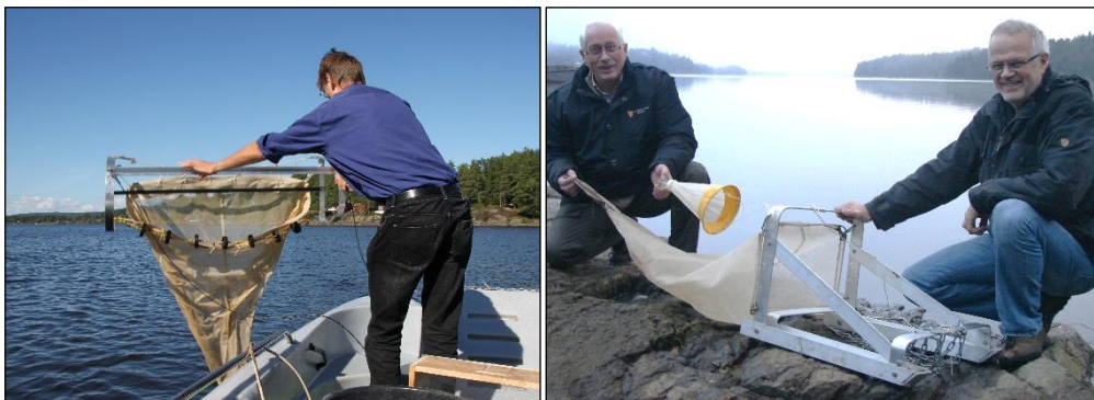
Figur 2. Bunnråll for fangst av istidskrepser. Bildet til venstre viser en svensk tråltype utviklet av Kalle Fürst. Trålen til høyre er produsert ved Kanalmuseet. Noen kjettinger fremst på trålsleden virvler opp bunns substratet, og mudder og eventuelle dyr fanges opp i trålposen. (Foto: Jan P. Vaaler (t.v.) og Ingvar Spikkeland).
