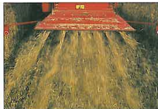
Skarpe kutterkniver og jevnt spredebilde gjør "halmproblemet" mindre.
